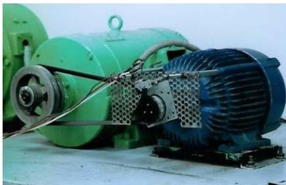
Fig. 2. Dispositivo de medición para la velocidad.
